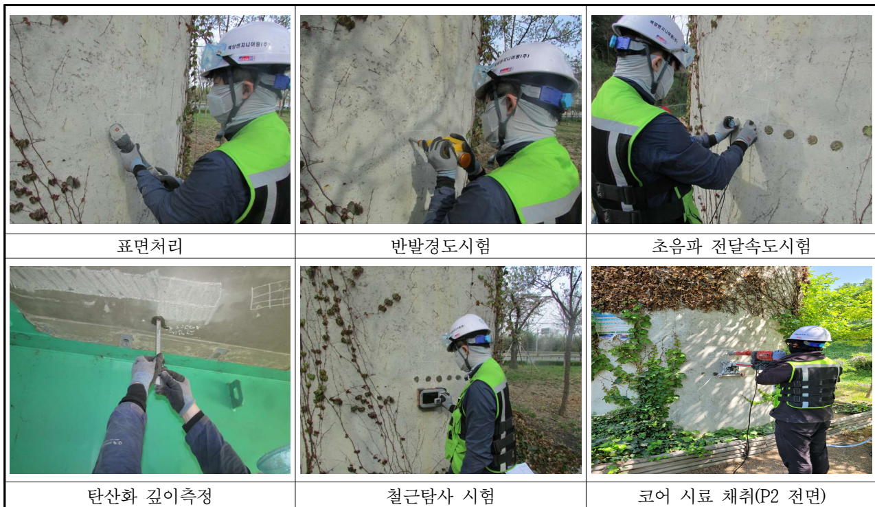
【사진 3.27】 콘크리트 내구성조사 전경
